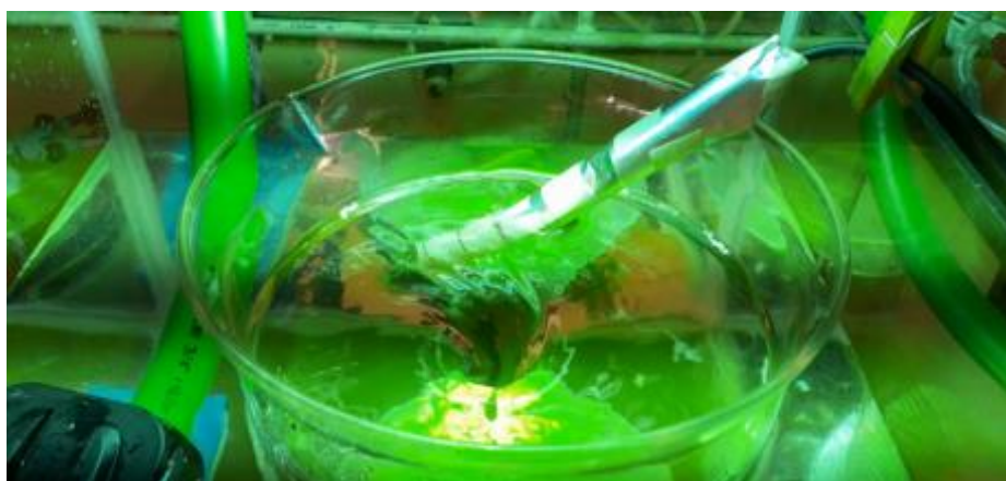
Figura 4. Vista superior do béquer contendo os MPs sob agitação.
