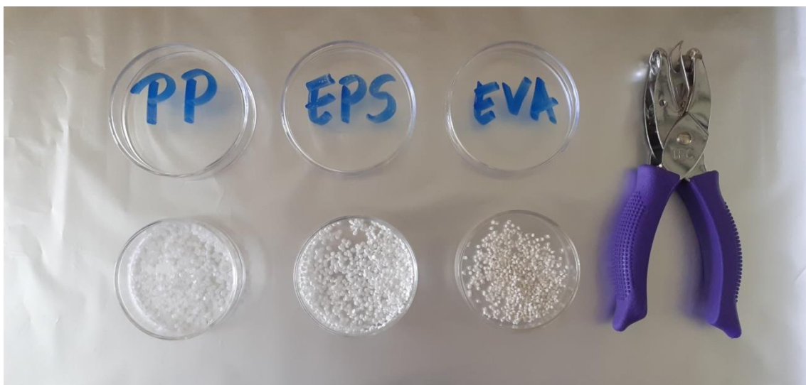
Figura 3. Microplásticos virgens produzidos manualmente a partir de materiais compostos de polipropileno (PP), poliestireno expandido (EPS) e etileno acetato de vinila (EVA).
