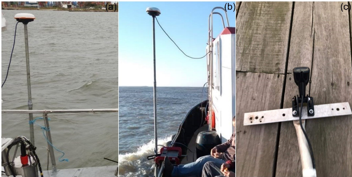
Figura 19: Exemplos de acoplagem das eco sondas à embarcação (a) na lancha “Larus” o equipamento acoplado em um suporte junto ao costado, com o GPS acoplado a outra extremidade do cano (b) no rebocador “4 irmãos” o transdutor da eco sonda junto ao costado e o GPS acoplado da mesma forma (c) exemplo de como o transdutor vai preso a extremidade submersa do cano.
