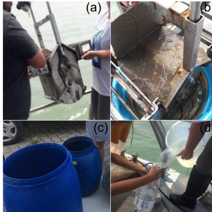
Figura 25: (a) e (b) Coleta e (c) armazenagem de sedimento e (d) água da antepraia da praia do Cassino no dia 30/01/2020 para calibração da sonda de medição direta. Fonte: acervo pessoal.
