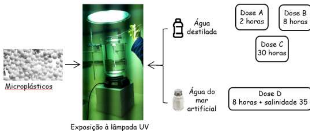
Figura 10. Diagrama do processo experimental, explicitando as condições aplicadas em cada tratamento.
