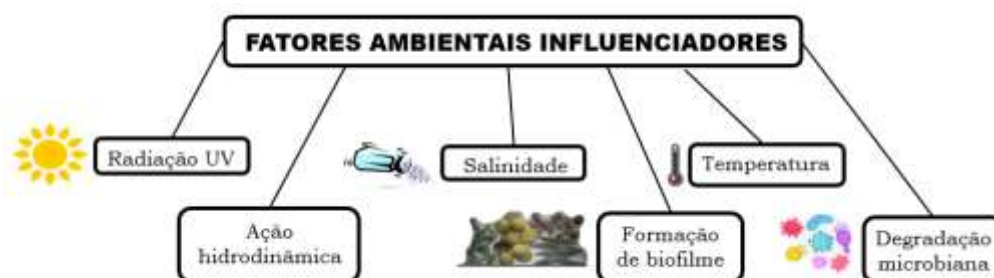
Figura 1. Principais fatores ambientais influenciadores dos processos degradativos dos polímeros sintéticos no ambiente aquático (Adaptado de Jahnke et al. 2017).
